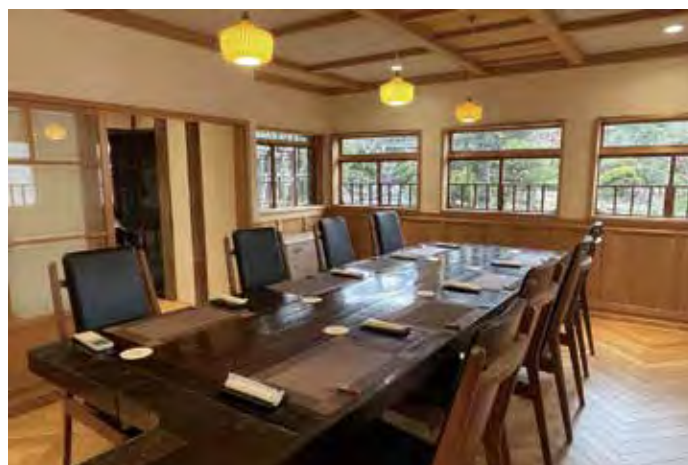
■ 増築した広間3。窓建具は古建具を再用。テーブル台板は当家で酒造りに使用していた酒槽(さかぶね)の部材を使用しています。
